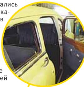
Коробка передач в ГАЗ-12 располагалась под рулем, поэтому впереди могли сидеть трое. Передняя панель металлическая, но покрашена под дерево (в довоенных машинах для отделки использовалась древесина). Приемник ламповый: перед тем, как заговорить, он грелся минут пять! Конечно, сейчас ездить на такой машине тяжело – например, нет привычного гидросилителя руля.
