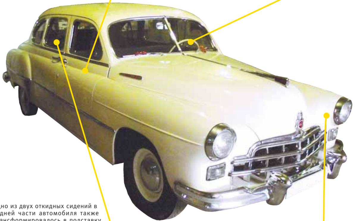
Одно из двух откидных сидений в задней части автомобиля также трансформировалось в подставку для ног. Задняя дверь распахивалась против движения и с внутренней стороны ручки для закрывания не имела – за солидным пассажиром ее всегда захлопывал шофер. Обивочная ткань из чистой шерсти, оплетка тряпчатая. В ГАЗ-12 три пепельницы на салон: для сидящих спереди, для пассажиров на откидных местах и тех, кто едет сзади. Последние даже могли воспользоваться стационарным прикуривателем!
